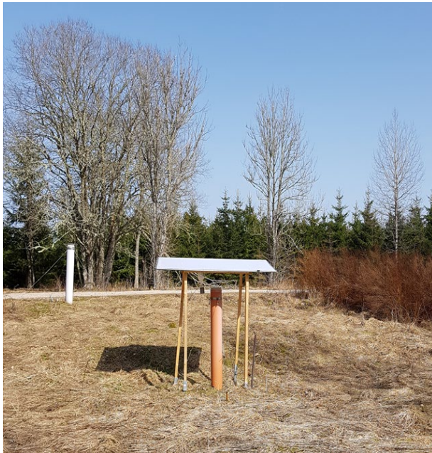
Figur 32. Insamlingsutrustning för nederbörd (WoF-provtagare), under och utanför ett tak.
